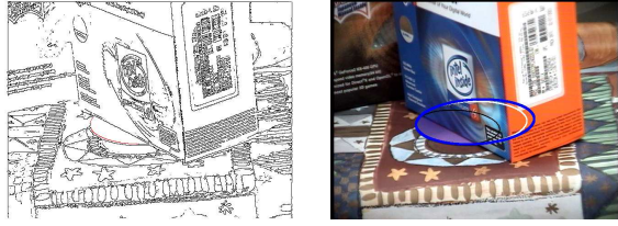
図 6: 円形物体をわずかに含む画像から検出したエッジ画像 (左), および楕円弧をなす 148 点に当てはめた楕円を原画像上に重ねて表示したもの (右): 細線は最小二乗法, 白線は Taubin 法, 太線は最尤推定解.
