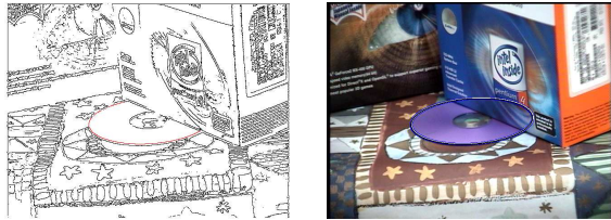
図 7: 円形物体を大きく含む画像から検出したエッジ画像 (左), および楕円弧をなす 414 点に当てはめた楕円を原画像上に重ねて表示したもの (右): 細線は最小二乗法, 白線は Taubin 法, 太線は最尤推定解.
