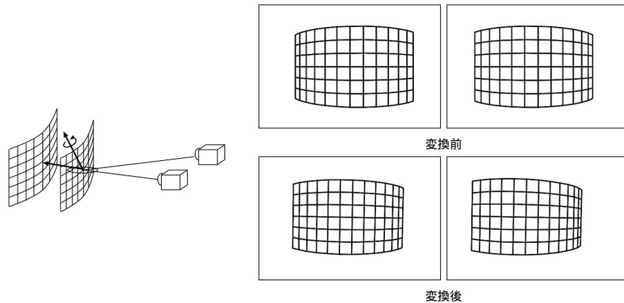
図 1 左：相似変換（回転，並進，スケール変化）する曲面格子ステレオ視による 3 次元計測と誤差楕円体．右：曲面格子の変換前後のステレオ画像のシミュレーション．
