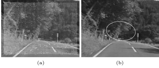
図2 (a) 道路シーン動画像から計算したオプティカルフロー (b) 推定したエピ極点とその信頼性評価
