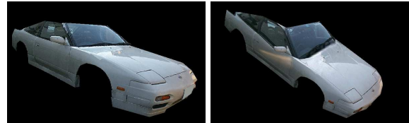
図 9 復元した乗用車の 3 次元形状
