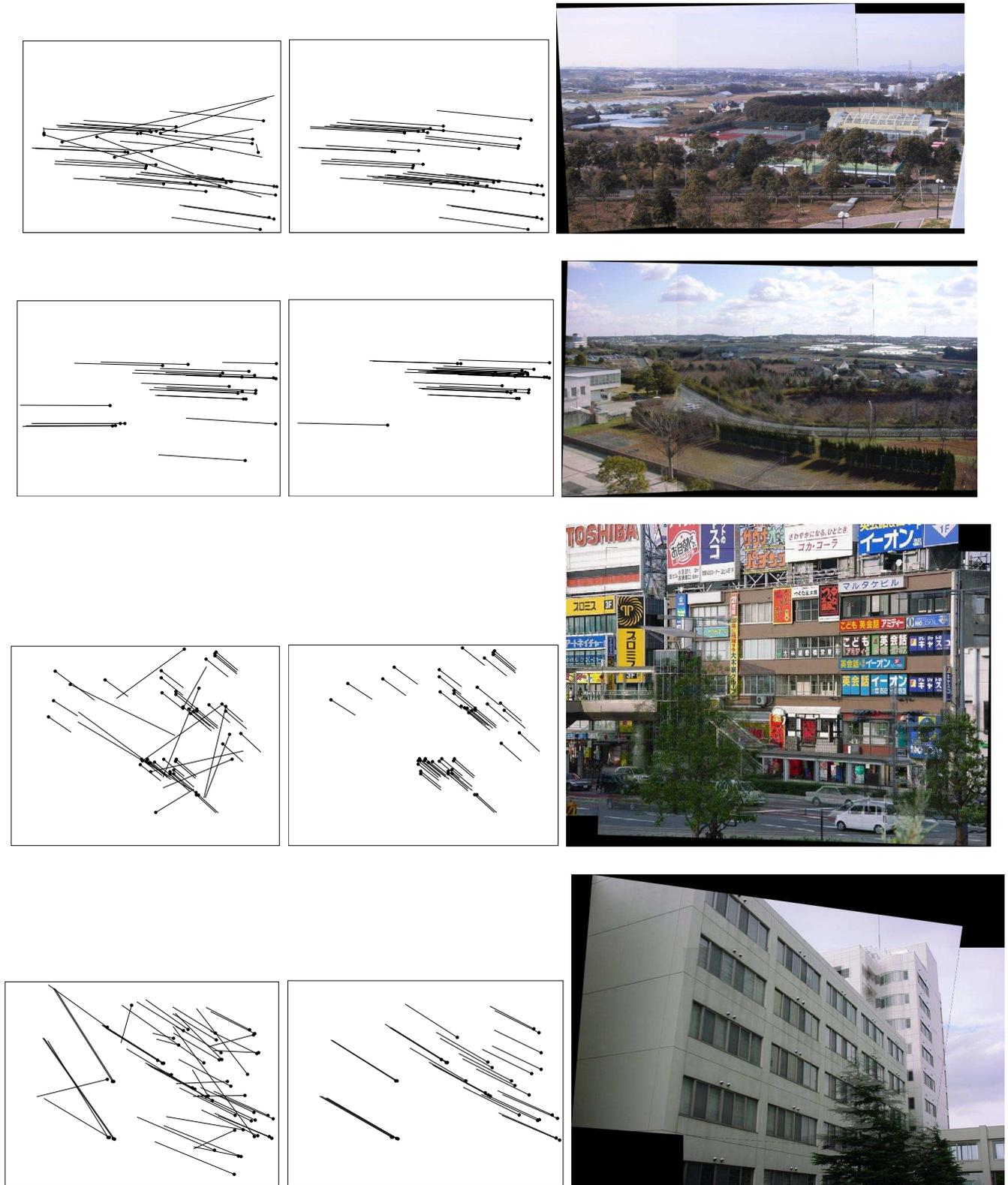
図 5: 左から順に図 1~4 で得られた対応, それからロバスト推定で得られる対応, およびそれから生成したモザイク画像.
