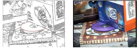
図 6: 円形物体を大きく含む画像から検出したエッジ画像 (左), および楕円弧をなす 414 点に当てはめた楕円を原画像上に重ねて表示したもの (右): 細線は最小二乗法, 白線は Taubin 法, 太線は最尤推定解．
