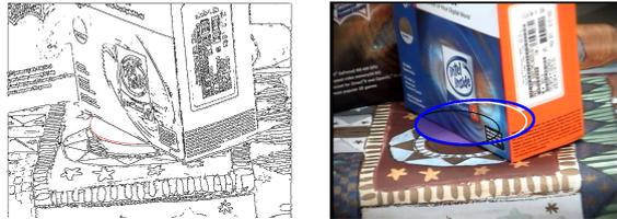
図 5: 円形物体をわずかに含む画像から検出したエッジ画像 (左), および楕円弧をなす 148 点に当てはめた楕円を原画像上に重ねて表示したもの (右). 細線は最小二乗法, 白線は Taubin 法, 太線は最尤推定解．
