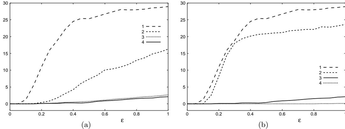
図 2: 2次元運動の分離の誤り率。(a) 1. 貪欲法, 2. 次元補正を加えたもの, 3. モデル選択を用いるもの, 4. 再分類を行うもの。(b) 1. 貪欲法, 2. 市村の方法, 3. 部分空間分離法, 4. 下界。
