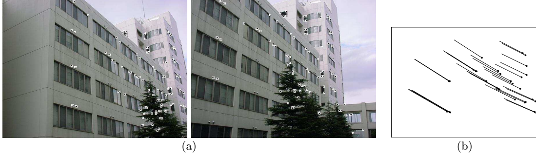
図 4: (a) 異なる位置から撮影した建物の画像から抽出した特徴点. (b) それらのうち, 対応する位置を線で結んだ「オプティカルフロー」(黒丸が左画像に対応). 各対応の端点は 4 次元空間の 1 点と同一視できる.
