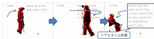
(図 3) 計測ソフトの動作画像：人物・関節情報をとくに、各動作時間を自動計測している
